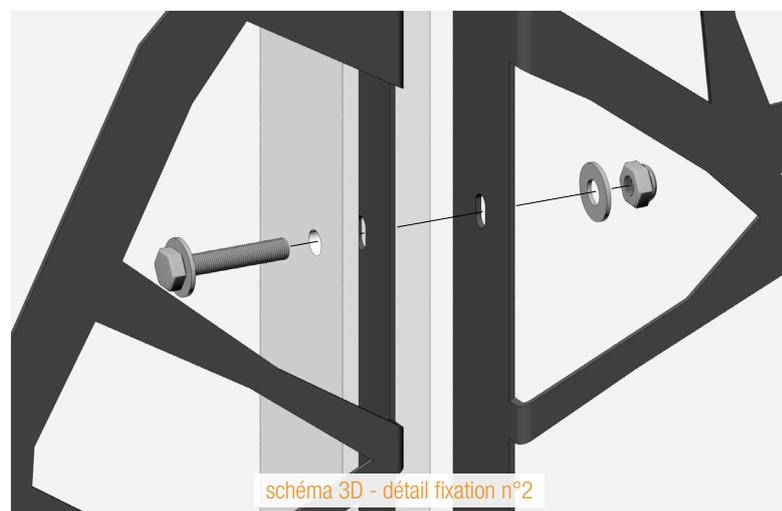
schéma 3D - détail fixation n°2
