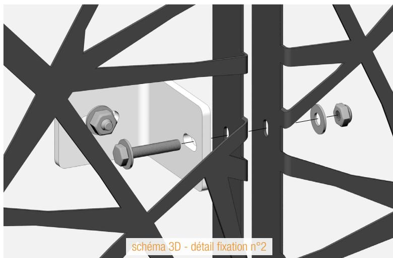
schéma 3D - détail fixation n°2
